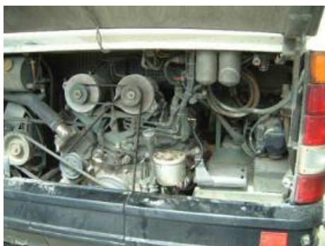
Figur 1: Kleenoilfilter installerat i en buss (foto från Kleenoils hemsida)
